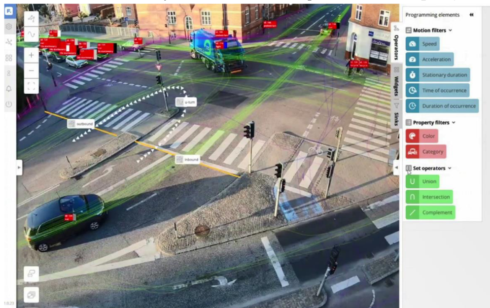
Obrázek 18: Příklad využití kamer MKMS pro sběr dat z dopravy – 111
