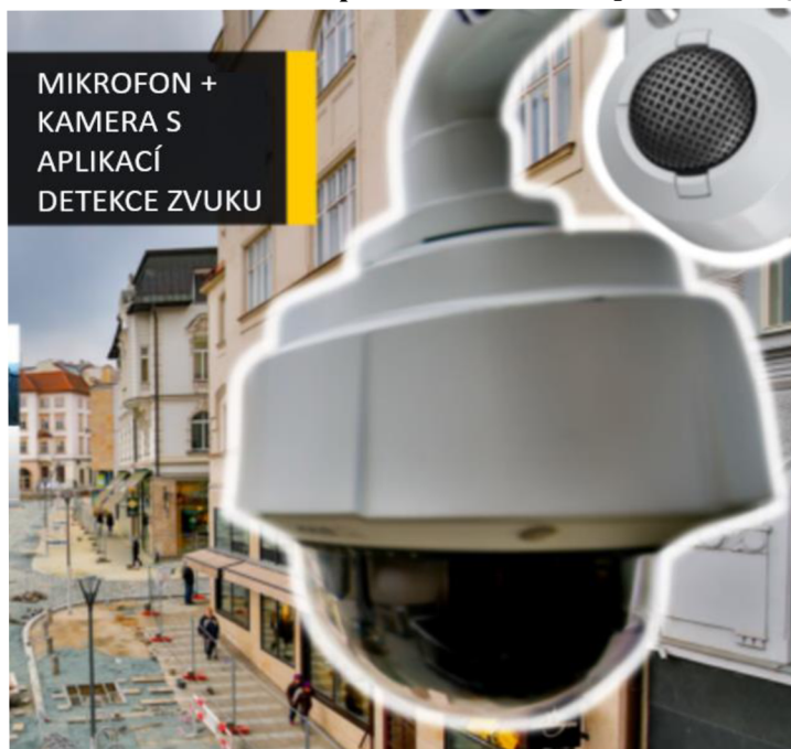
Obrázek 10: Příklad využití dohledové kamery současně jako detektoru pro klasifikaci a lokalizaci nebezpečných zvukových událostí díky připojenému mikrofону a schopnosti kamery instalovat dodatečné aplikace do svého operačního systému 103
