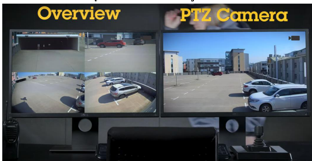
Obrázek 7: Pohled operátora při využití kombinace panoramatické (vícesměrové) kamery s otočnou kamerou v jednom těle 100
