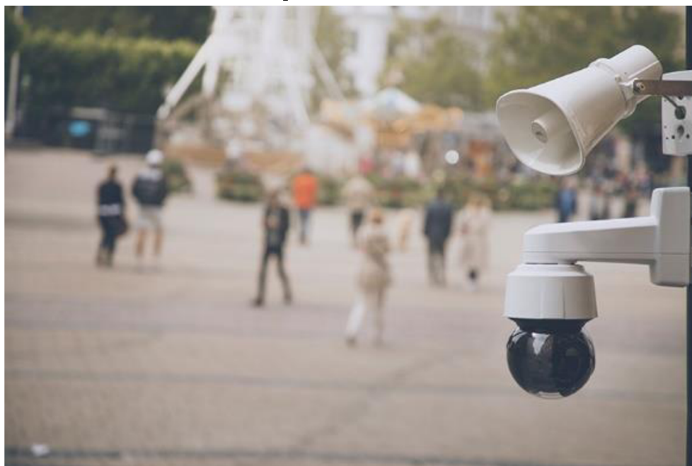
Obrázek 12: Příklad vyžití dohledové kamery s video analytickými funkcemi a s připojeným reproduktorem pro zvýšení prevence kriminality v otevřeném prostoru 105
