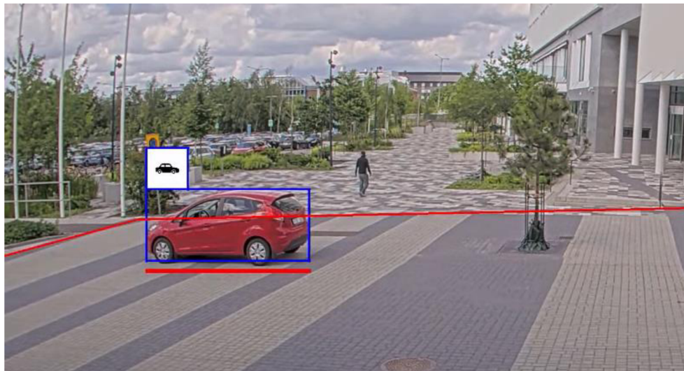
Obrázek 14: Příklad automatické detekce objektu přímo kamerou (tzv. „edge analytics“) 107
