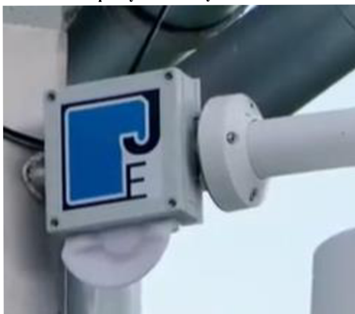
Obrázek 11: Příklad samostatného čidla pro jako detektoru pro klasifikaci a lokalizaci nebezpečných zvukových událostí 104
